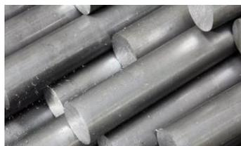
**Resistência ou tenacidade:** um objeto feito de material resistente é mais difícil de ser quebrado quando submetido a um impacto, como uma queda ou uma martelada. O aço é um material resistente e, por isso, é usado como parte da estrutura das construções.
